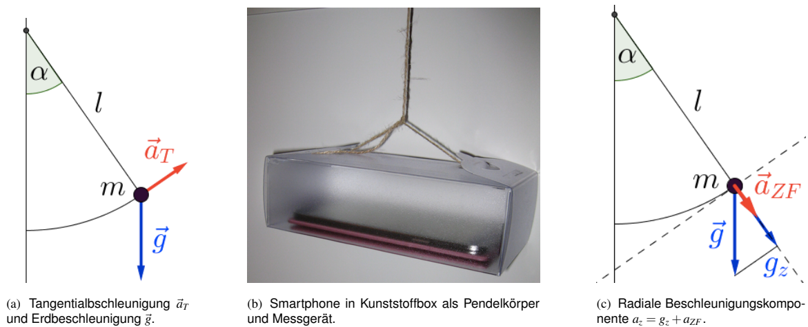
Abb. 1: Realisierung eines Fadenpendels mit einem Smartphone zur Messdatenerfassung.
